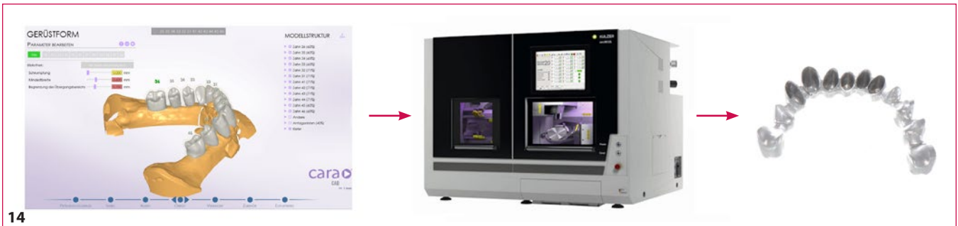
Abb. 13 Dank des Designs über den vollanatomischen Ansatz konnte die Reiseprothese hergestellt werden. Abb. 14 Die Sekundärkonstruktion wurde nach der vollanatomischen Reduktion in NEM gefertigt.
