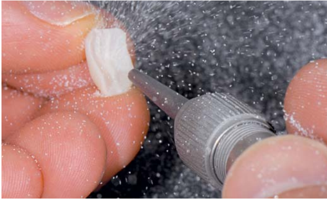
Abb. 31 Wenn die Verblendschalen zusätzlich mit Signum Komposit farbig individualisiert werden sollen, empfiehlt sich, die Innenseite ausdünnen. Dann wird mit Aluminiumoxid (Korngröße: 50 µm) abgestrahlt.
