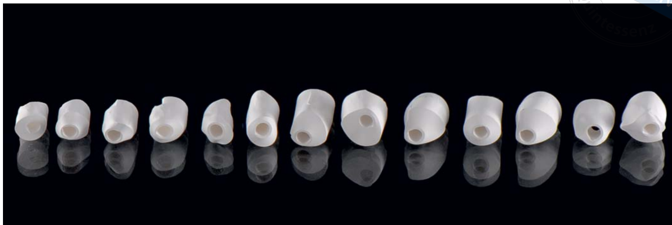
Abb. 17 Die gefrästen Primärteleskope vor dem Sintern.
