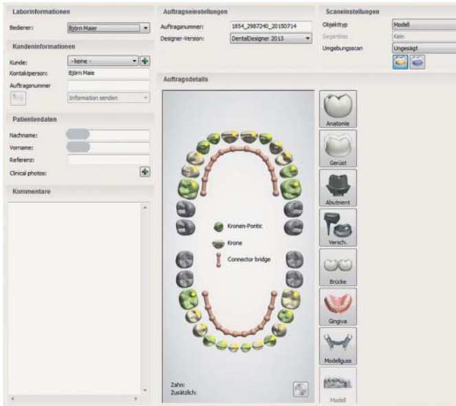
Abb. 25 Computergestützte Konstruktion der Reiseprothese, die als Provisorium dient: Angelegt wird der Auftrag als vollanatomische Brückenkonstruktion, wobei die bereits gespeicherte Primärkonstruktion der Teleskopprothese als Ausgangssituation dient.
